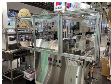
【ブース正面には両端圧着・片端ハウジング挿入機のIoTモデル『JN07SD-IS-C』を展示しています。独自の機能である異常時録画機能付き稼働監視システムの実演も行っています。】
