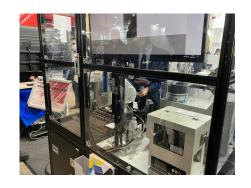
【当社ブース正面では電線切断~フェルール端子圧着~端子台挿入工程を協働ロボットを用いた搬送実演を行っています。】
