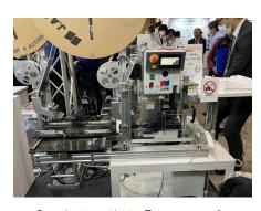
【半自動圧着機『MCD250S』ではバーコードリーダーとアプリチェンジャーによる作業工数短縮のご提案を行っています】
