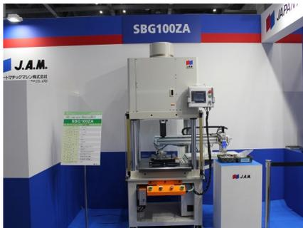
【新聞発表した4柱型フレームサーボプレス機「SBG100ZA」は搬送ユニットによる自動化の実演をしています】
