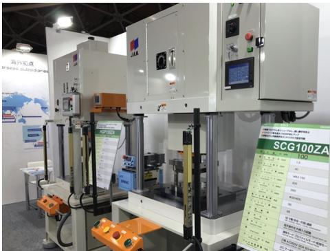
精密プレスは4柱クランク式サーボプレスSCG100ZA、フルロード仕様サーボプレスSBP1000AEなどを展示しています。
