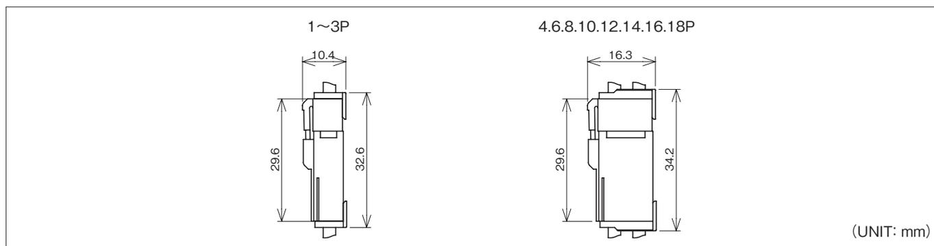
**パネル取付穴寸法 PANEL HOLE SIZE**
