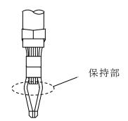
◇ 通常 5 N 程度の力であれば挿入できますが、極度の負荷を感じた場合、ターミナルが基板に対し傾いているか、ターミナルが変形している可能性がありますので確認して下さい。
