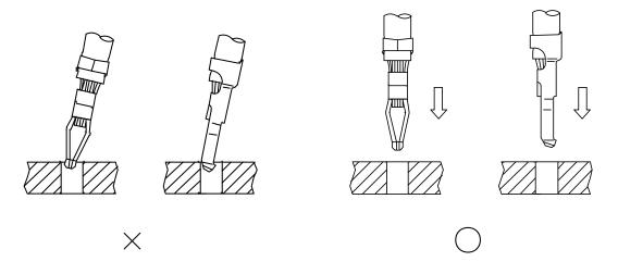
◇ 目視によりターミナルが基板にしっかりと装着されていることを確認してください。 Through visual inspection make sure that the terminal is locked in the board.
