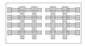
◇ 基盤挿入部の変形や異物の付着を防ぐために厚手の紙のような包装材料にてターミナルを 保護し適切な箱の中に収納してください。
