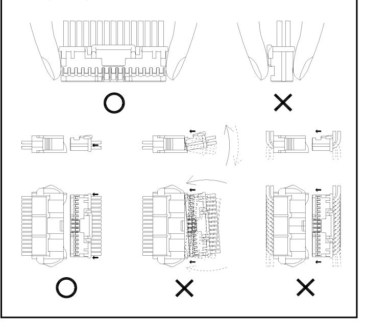
◇ RECハウジングからの引き抜き時は、PLUGハウジングのロック解除部を押さえて電線を保持しながらロックを完全に解除した状態で真っ直ぐに抜いて下さい。ロックが完全に解除されていない状態で引き抜くとロック部の破損原因となります。また電線(特に少数本)を引っ張って抜かないで下さい。(ターミナルが抜けてしまう恐れがあります。)
