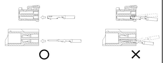
◇ ターミナルがハウジングから外れてこないかを確認するために、1本1本の電線を軽い カ(3.0 N程度)で引っ張ってしっかり挿入されていることを確認して下さい。 Pull the wire with light force (approx. 3.0N) to confirm whether the terminal would not come off. ◇ さらに、目視によりターミナルがハウジングのランスにしっかりとロックされていることを確認して下さい。
