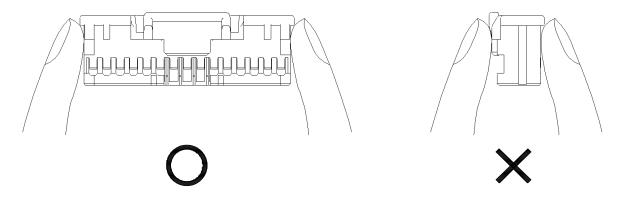
◇ ターミナルは途中で止めずにハウジングのいちばん奥まで挿入して下さい。 ターミナルがハウジングに完全に挿入されるとランスが元に戻り、ターミナルはランスに引っ掛かり保持されます。
